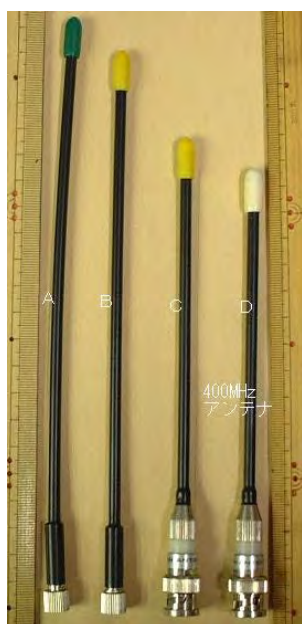
図 19 無指向性アンテナ：ロッドアンテナの例
